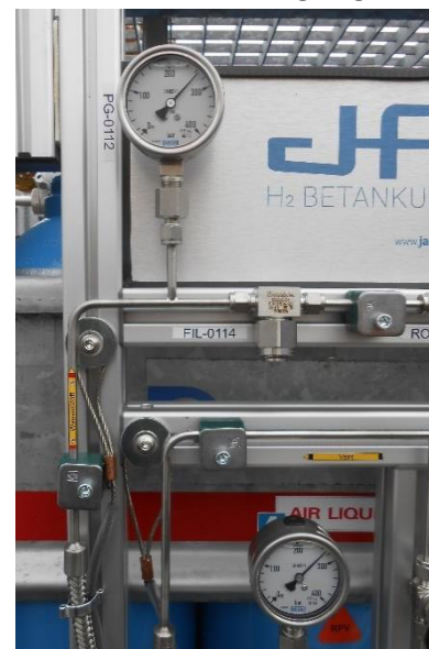
Abbildung 10: Tankpanel nach Druckbereich mit Fahrzeugtank bei 250 bar
