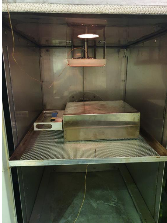
Abbildung 10: Beispielhafte Messpositionierung von Temperaturfühlern sowie einem Datenlogger (Mitte), welcher ausgestattet mit verschiedenen Sensorsystemen, zur Grundcharakterisierung des Wasserstoffbackofens (u.a. Datenermittlung zur Berechnung des Wärmestrom, der Luftströmungsgeschwindigkeiten etc.) eingesetzt wird .
