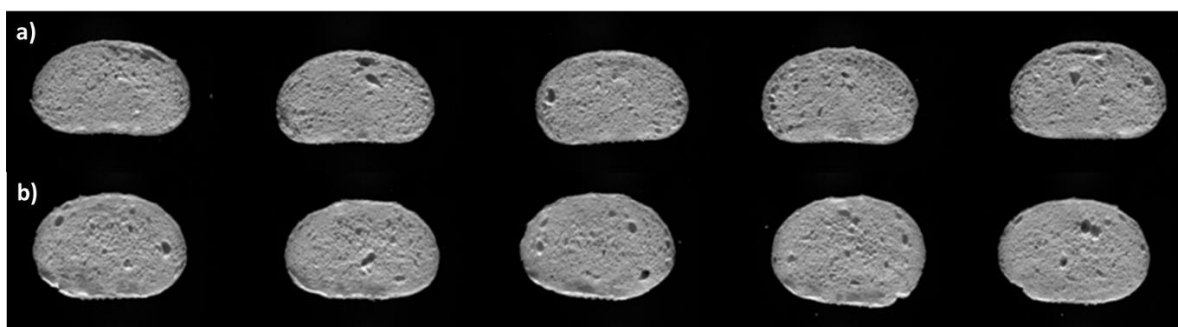
Abbildung 21: Aufnahmen der Krumenstruktur durch das digitale Imaging-System C-Cell (a)= Konvektionsbackofen; b)=Wasserstoffbackofen)
