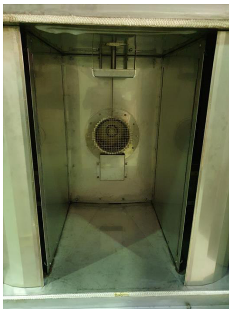
Abbildung 7: Produktraum des Wasserstoffbackofens mit integrierter Verdampferschale, welche an der Decke des Wasserstoffbackofens angebracht ist.
