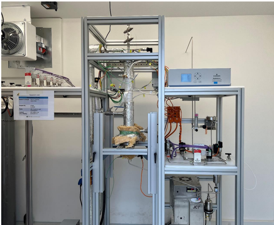
Abbildung 5.4: Versuchsanlage zur Methanisierung im Technikcontainer
