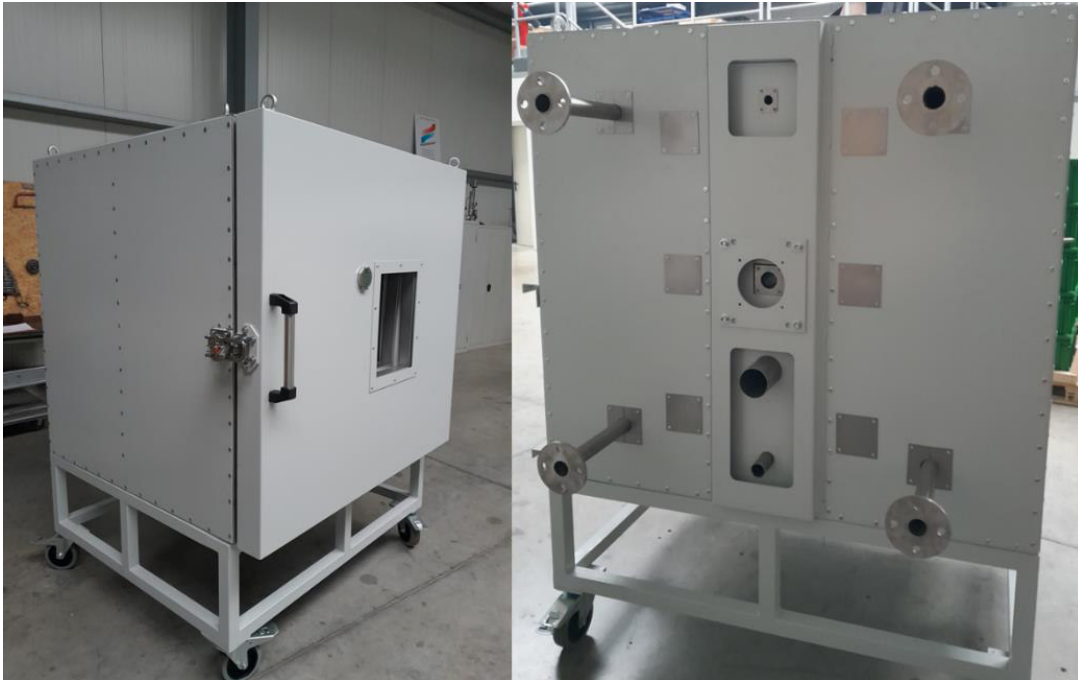
Abbildung 6: Grundbau des Wasserstoffbackofens nach Fertigstellung des Ofengehäuses und des Innenofens.
