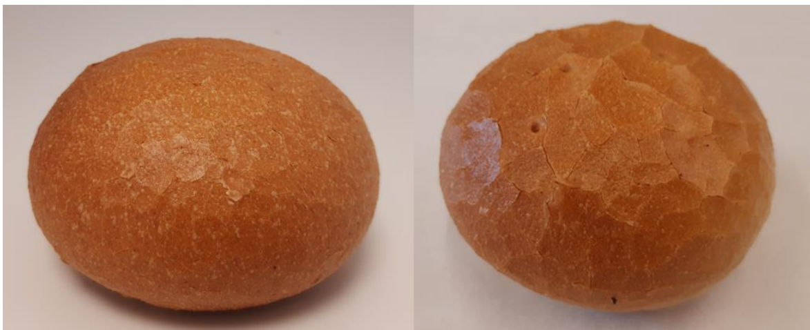
Abbildung 19: Vergleich der Backwarenqualität zwischen Brötchen hergestellt mit einem industriellen Konvektionsbackofen(links) und dem entwickelten Wasserstoffbackofen (rechts).
