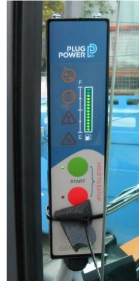
Abbildung 9: Controlpanel des Brennstoffzellensystems
