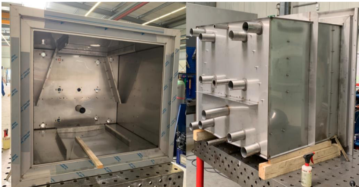
Abbildung 5: Blick in den Innenofen (links) sowie Rückansicht des Ofengehäuses (rechts) während der Fertigungsphase des Wasserstoffbackofens.
